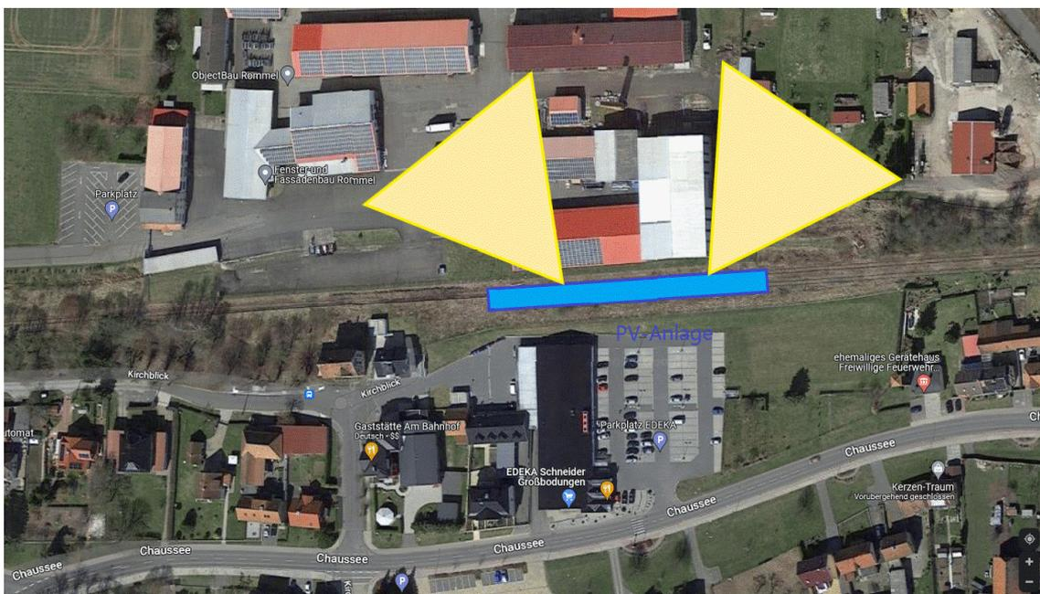
Abbildung 8: Schematische Darstellung der Blendwirkung der geplanten Anlage bei Modulneigungen größer 55°.
